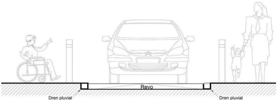
Alzado: dren pluvial en calle a nivel
