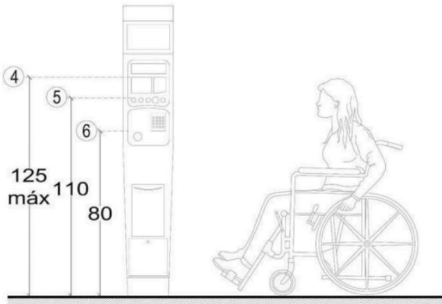
Detalle en alzado, parquímetro
