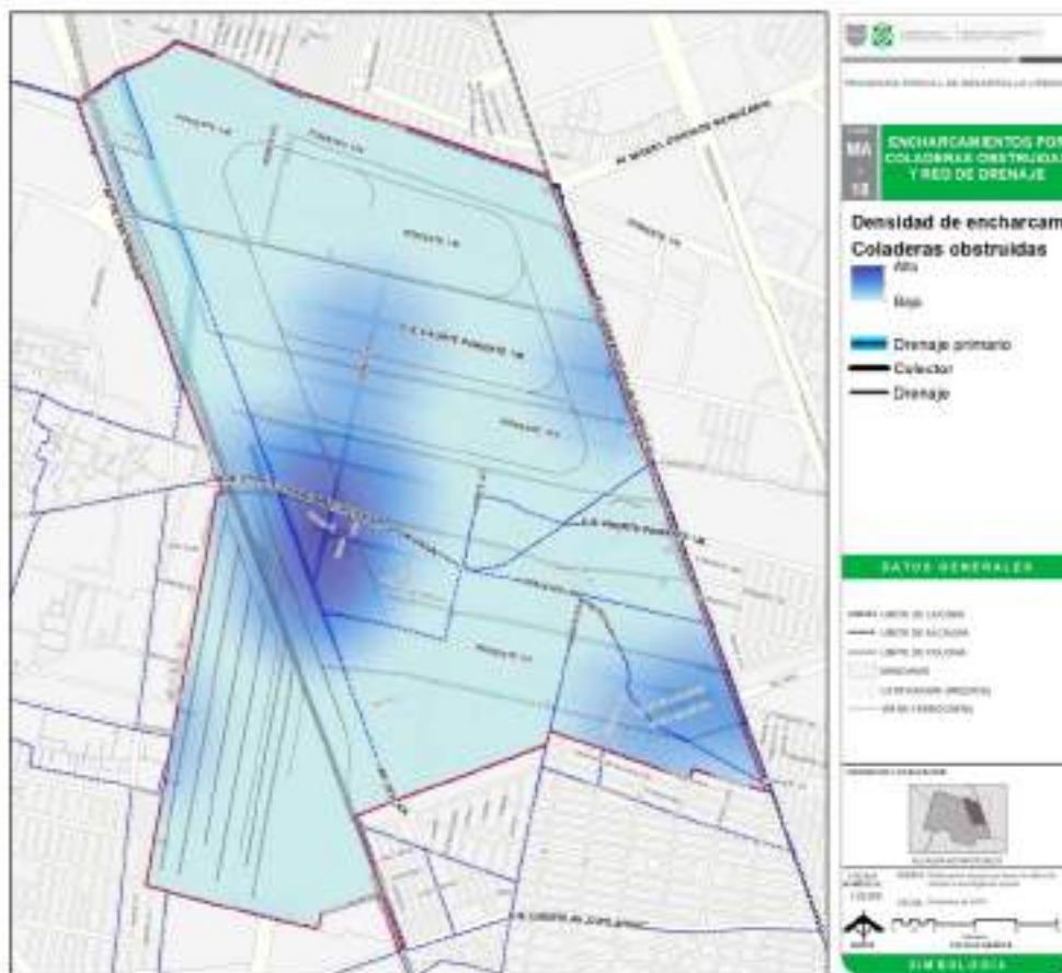
Imagen 22. Encharcamientos por coladeras obstruidas y red de drenaje
