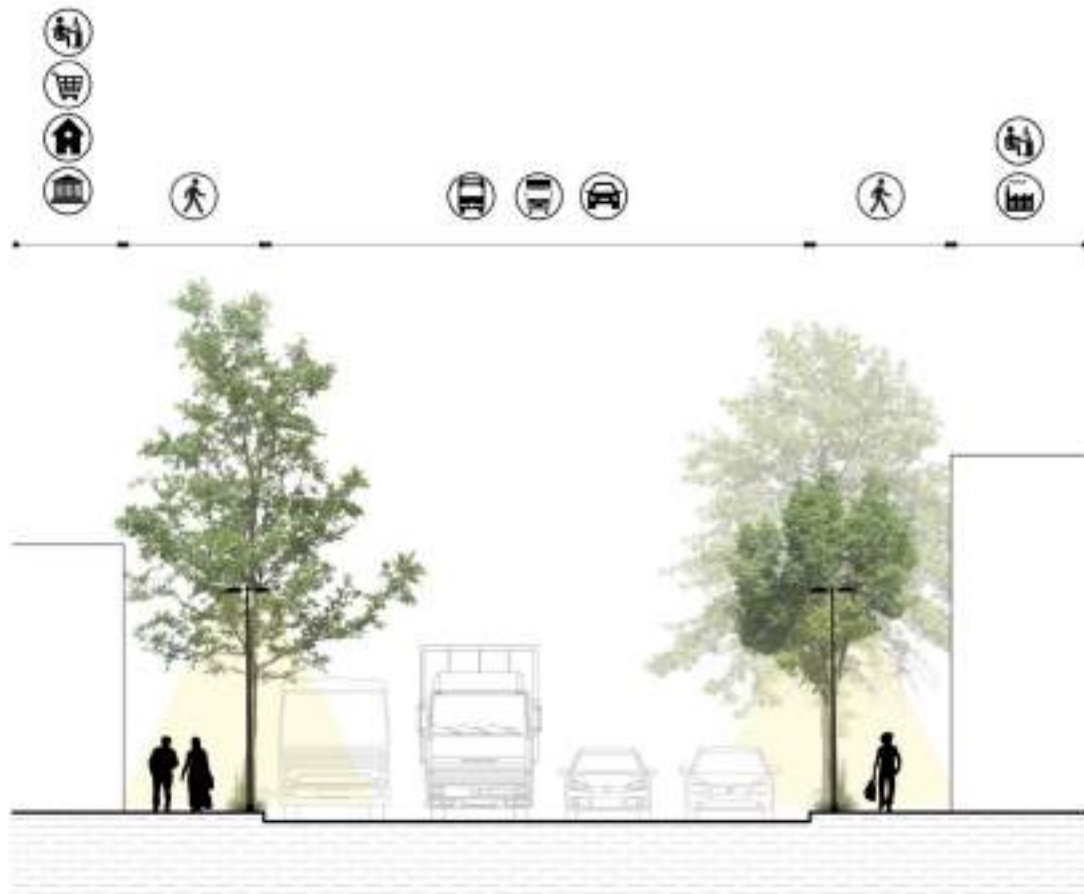
Sección tipo 1. Corredor Urbano Eje 4 Calzada Azcapotzalco - La Villa
